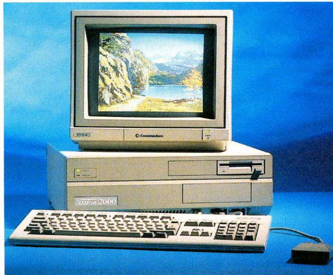
Amiga 2000: Auch hier ist viel Platz für Erweiterungskarten vorhanden, wie SCSI-Host-Adapter Turbo- und RAM-Karten
